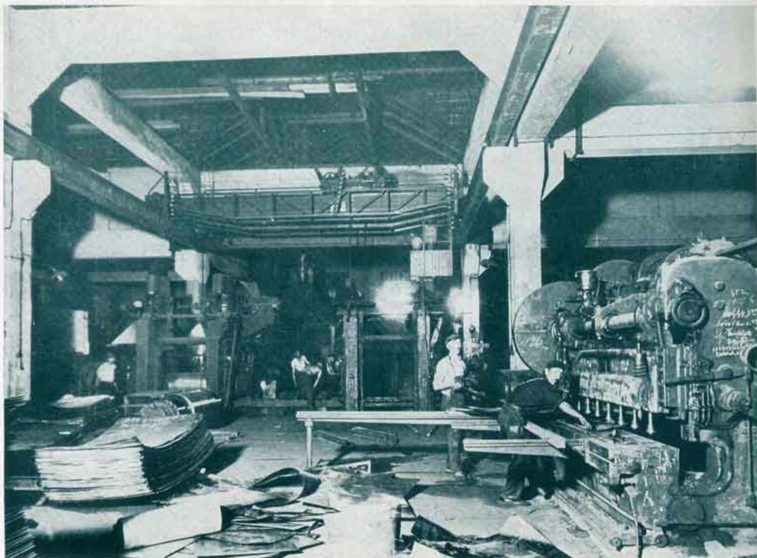
Маказе за обрубљивање лимених плоча; у позадини машине за ваљање; над њима електрична помична дизалица носивости 15 тона.
